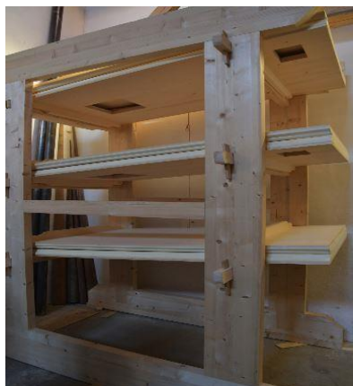
Foto: Nová měchová konstrukce.
